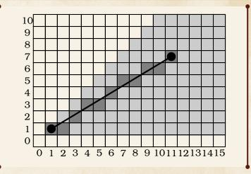
Bruteforce: Linie durchziehen. Pro x-Wert wird das Kästchen genommen, zu dessen Mittelpunkt die Linie am nächsten ist. In Grenzfällen muss in die Geradengleichung eingesetzt werden und y gerundet werden.
