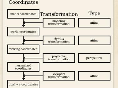
Bei der Rendering Pipeline wird vor der Projektiven Transformation noch die Beleuchtung gemacht. Danach wird geclippt (Alles außerhalb des definierten Bildschirmausschnittes wird abgeschnitten) und Rasterisiert.
