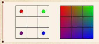
Farbwerte werden abhängig zur Entfernung zur nächst gelegenen Farbe berechnet. Will man z.b. den Farbwert des Mittelpunktes eines Quadrates berechnen, dann nimmt man die Summe der Multiplikation der Farbwerte mit 0.25.
