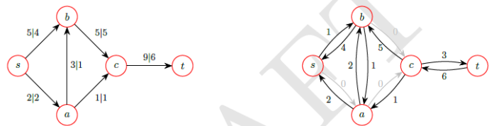
(a) Netzwerk mit maximalem Fluss (b) Residualgraph (Es ist kein erweiternder Weg vorhanden)
